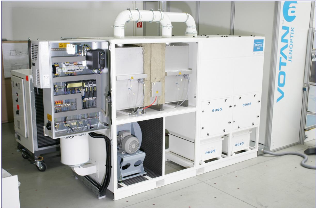
*Abb. 1: Adsorptionsanlage zur Abluftreinigung mit integrierter katalytischer Nachverbrennung für 1.500 m<sup>3</sup>/h*
